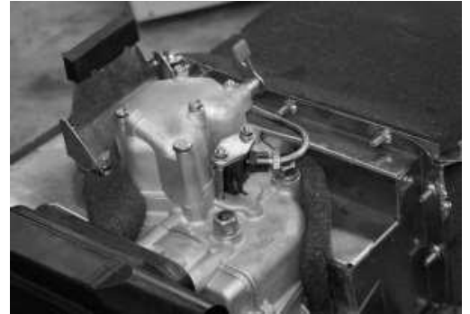
Кришка перевірки очисника повітря.
