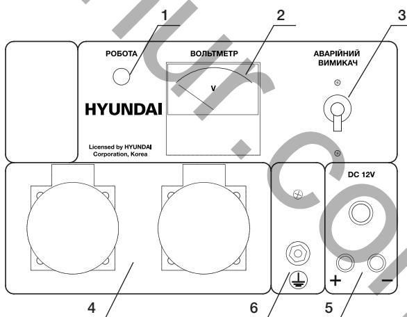
1. Індикатор роботи двигуна.
