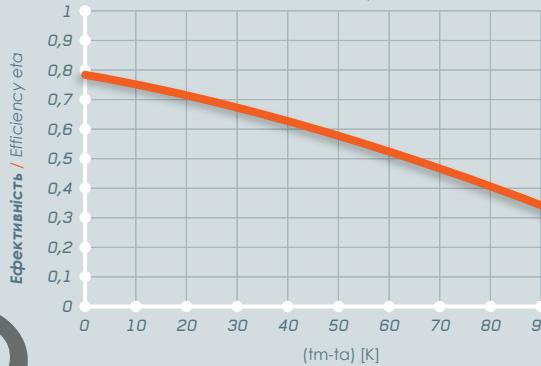
**Потужність колектора (при G=1000 Вт/м<sup>2</sup>) / Collector capacity (for G=1000 W/m<sup>2</sup>)**
