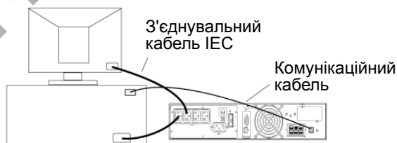
Мал. 5. Приклад підключення пристроїв Plug & Play
