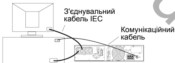
Мал. 5. Приклад підключення пристроїв Plug & Play
