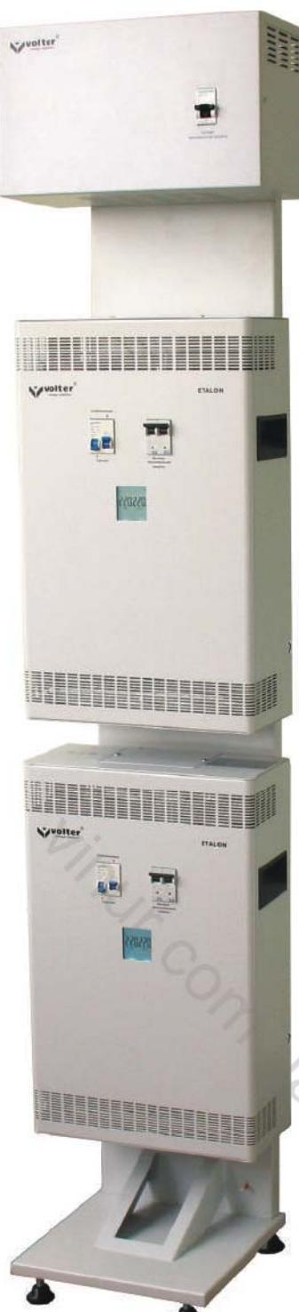
**Стабилизаторы напряжения Etalon мощностью 18, 22 и 27 кВт** конструктивно состоят из 2-х одинаковых стабилизаторов половинной мощности 9, 11, и 14 кВт соответственно. Стабилизаторы объединяются при помощи специальной стойки с общим автоматическим выключателем и работают параллельно на общую нагрузку. При этом все технические характеристики сохраняются.
