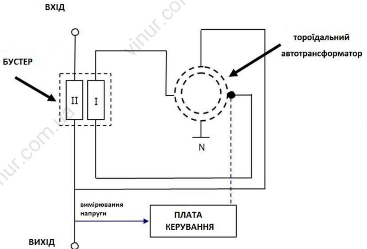
Мережа та потужності користувача підключаються до вторинної обмотки бустера. Первинна обмотка знаходиться у гальванічній розв'язці з вторинною та підключена до автотрансформатора. Плата управління вимірює напругу на виході стабілізатора та передає сигнал на привід автотрансформатора. При збільшенні або зменшенні напруги на вході стабілізатора, напруга зі вторинної обмотки буде додаватись або відніматись напруга первинною обмоткою. Точність стабілізованої напруги не перевищує 1%.
