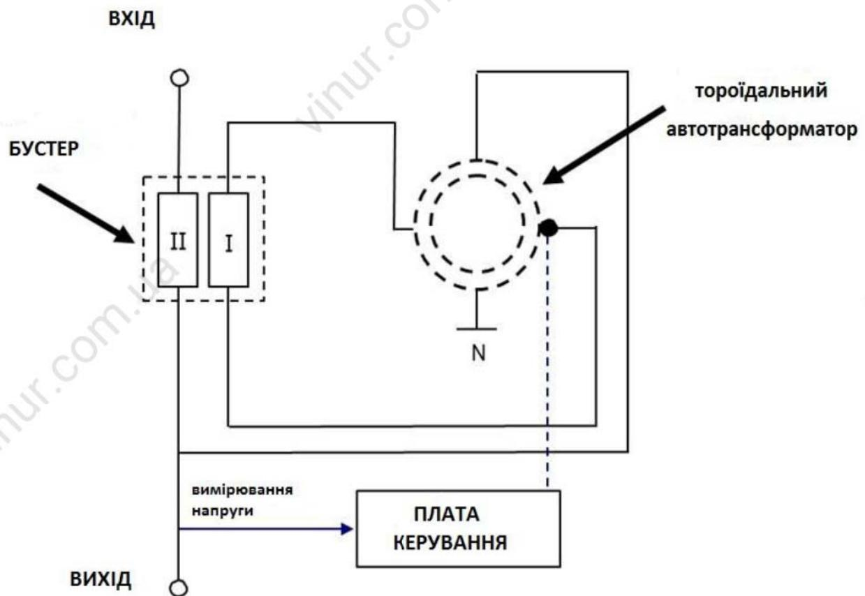
Мережа та потужності користувача підключаються до вторинної обмотки бустера. Первинна обмотка знаходитьться у гальванічній розв'язці з вторинною та підключена до автотрансформатора. Плата управління вимірює напругу на виході стабілізатора та передає сигнал на привід автотрансформатора. При збільшенні або зменшенні напруги на вході стабілізатора, напруга зі вторинної обмотки буде додаватись або відніматись напруга первинною обмоткою.
